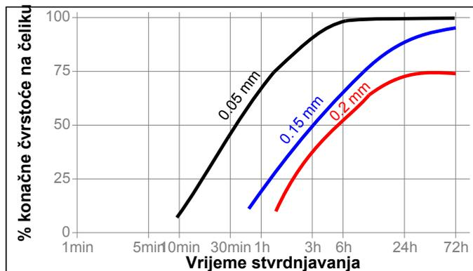
Brzina stvrdnjavanja ovisno o temperaturi. Brzina stvrdnjavanja ovisi o temperaturi. Grafički prikaz ispod pokazuje razvijanje čvrstoće u odnosu na vrijeme pri različitim temperaturama kod M10 čelične matice i vijka testirano prema ISO 10964.
