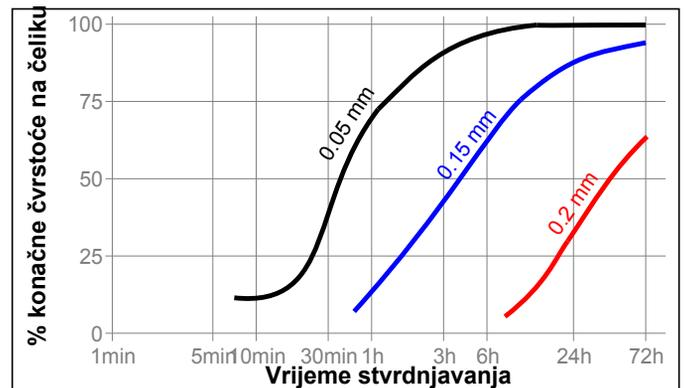
**Brzina stvrđnjavanja ovisno o temperaturi** Brzina stvrđnjavanja ovisi o temperaturi. Grafički prikaz ispod pokazuje razvoj smične čvrstoće ovisno o temperaturi kod čeličnog rukavca i prstena testirano prema ISO 10123.
